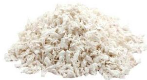
Le micro-fibre naturali si disperdono agevolmente all'interno della matrice contribuendo a formare un composto omogeneo resistente al ritiro ed alle micro-fessurazioni.
