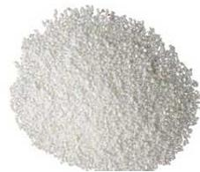
Materia prima altamente tecnologica formata da sfere spanse ultra leggere, completamente inorganiche, inerti e dotate di ottima resistenza al fuoco (Euroclasse A1). Possiedono:
